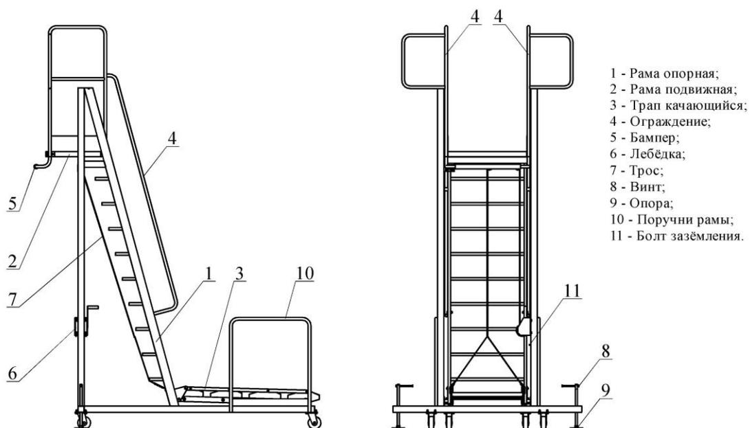
Рисунок 1 - Общий вид площадки обслуживания ПО-13
