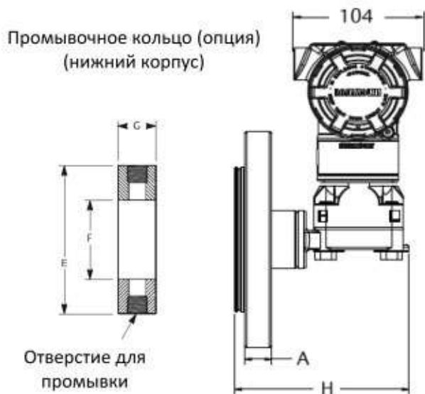
Рис. 13. Преобразователь 3051L с фланцем заподлицо.
