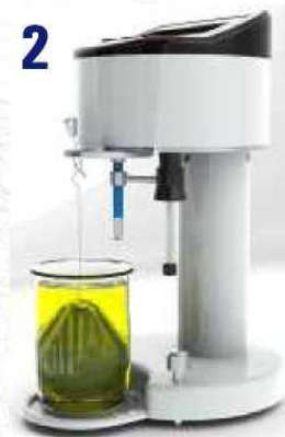
Взвесьте поплавок в жидкости
