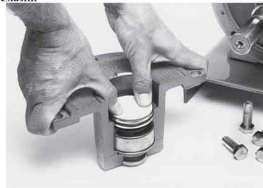
ВНИМАНИЕ: Вышеприведенная фотография сделана на разрезе для лучшей иллюстрации. Вывернуть головку и установить новое уплотнение консистентной смазки, повернув его вниз и вдавливая его в просверленное отверстие позади главного подшипника. Это лучше сделать с использованием старого седла уплотнения со снятым кольцевым уплотнением. Нанести обильное количество легкого смазочного масла на новое седло уплотнения. Используя защитный диск, осторожно вжать уплотнение на место.
