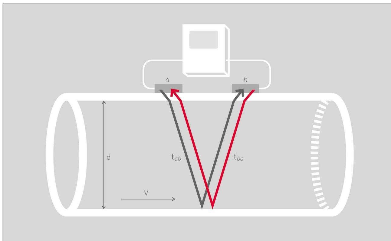
Ультразвуковые сигналы  $ab$ , посланные датчиком  $a$  по течению, пересекают поток быстрее, чем сигнал  $ba$ , посланный датчиком  $b$  против течения.
