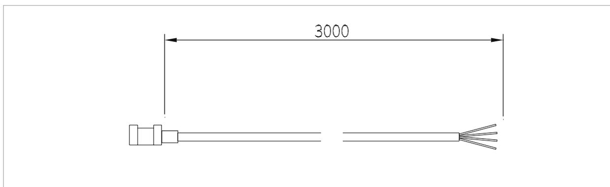
Температурный датчик типа PT100 (размеры в мм)
