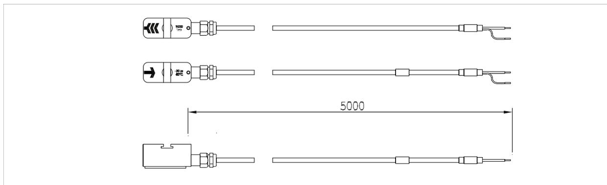
Датчики типа K4L (размеры в мм)
