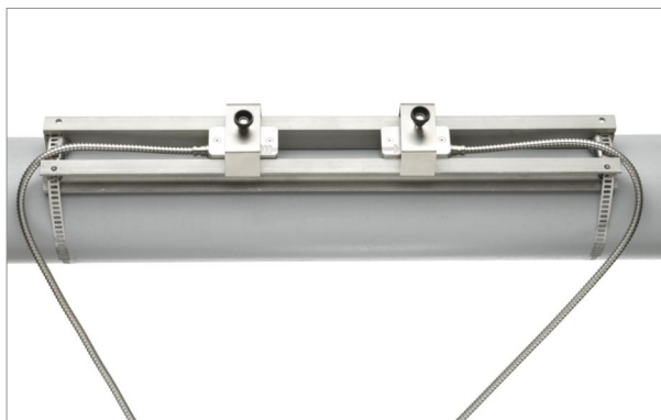
Установочные рельсы с датчиками на трубе
